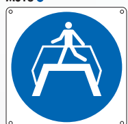
E13 95 KWX È obbligatorio utilizzare il ponte pedonale M023 ●
