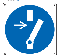
E13 73 KWX È obbligatorio disconnettere il macchinario prima di effettuare manutenzioni o riparazioni M021 ●
